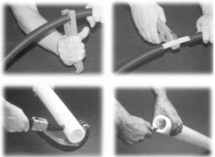
Рисунки 34-37: Способы разрезания труб
